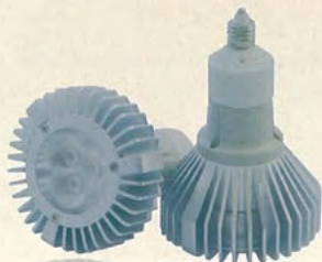
55W用 PAR20型 (ハロゲンビームランプ55W相当) 最大消費電力: 8~9W
